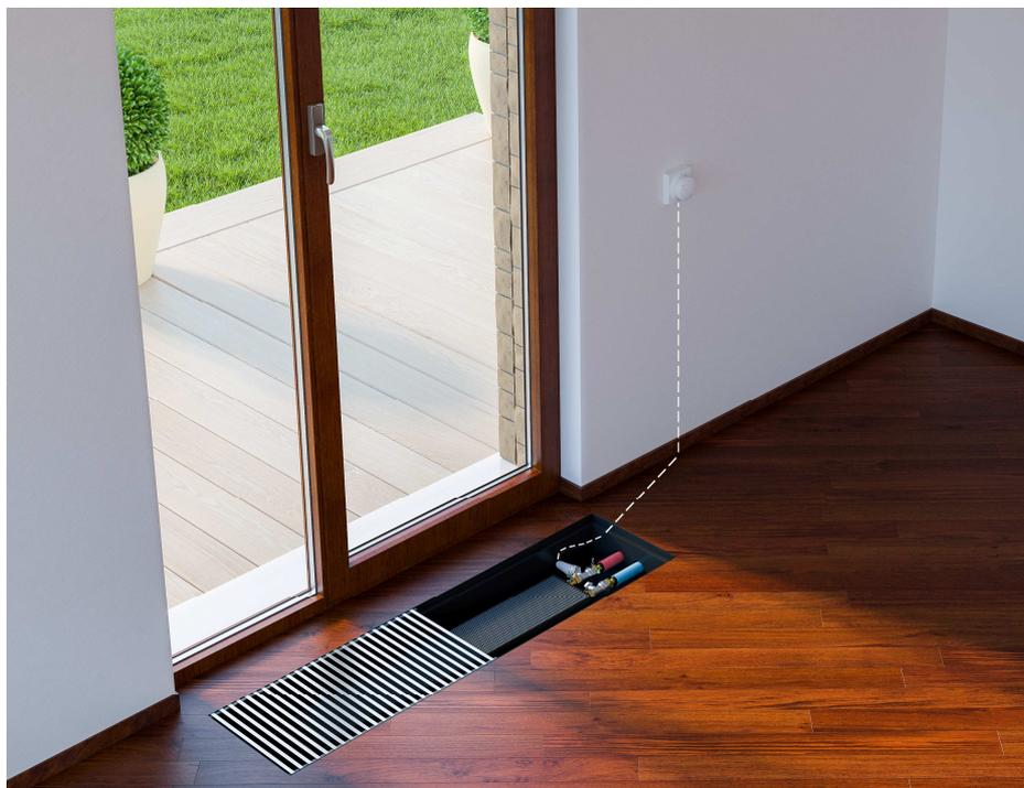
2) В случае, когда требуется электрическая регулировка, одним из способов является применение комнатного регулятора температуры вместе с термическим сервоприводом и клапанами. Регулятор измеряет температуру в помещении при помощи встроенного датчика и поддерживает заданное значение температуры. Когда температура в помещении упадёт ниже заданного значения на термостате, термический сервомотор откроет клапан. Комнатный регулятор температуры должен быть расположен
