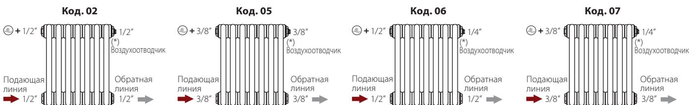
Для радиаторов TESI высотой более 1000 мм или радиаторов, содержащих менее 15 секций, рекомендуем использовать диафрагму.
