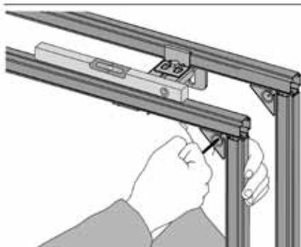
Профили выравниваются при помощи уровня и соединяются угловыми соединениями
