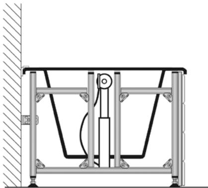
Несущая конструкция TECEprofil при монтаже сифона
