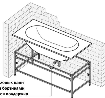
При монтаже акриловых ванн с неукрепленными бортиками может понадобиться поддержка бортиков за счет дополнительных горизонтальных профильных стоек.
