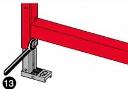
Одинарные крепления устанавливаются посередине встраиваемого модуля или поперечной стойки, опора модуля устанавливается на профиль, необходимо ослабить болт тормозного механизма
