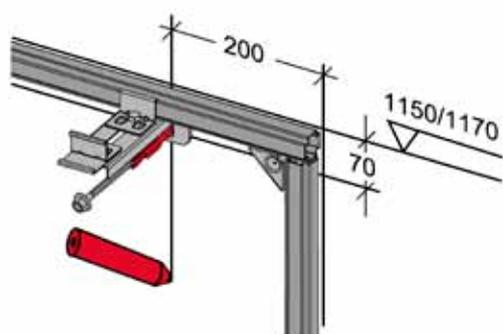
Профили крепятся к стене при помощи двойных креплений, к полу - при помощи одинарных
