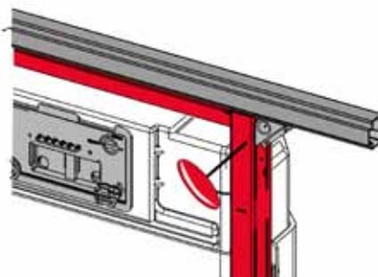
Вставить модуль, зафиксировать его на верхнем профиле при помощи угловых соединений, установить тормозной механизм, затянуть болты на опоре модуля (только усилием руки!)
