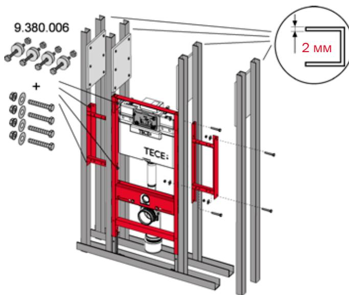
Защитная гофротруба для проводной активации смыва должна быть соединена со стальной пластиной и поставляемыми в комплекте штуцерами. Таким образом, гарантируется надежное крепление данной трубы на протяжении всего строительного периода. Опорные пластины всегда должны поддерживаться несущим строительным элементом при помощи прилагаемых стеновых креплений.
